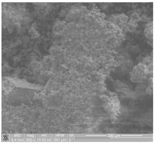
Рис. 9. Микрофотография субстанции таурина после 15 минут измельчения (электронная микроскопия)
