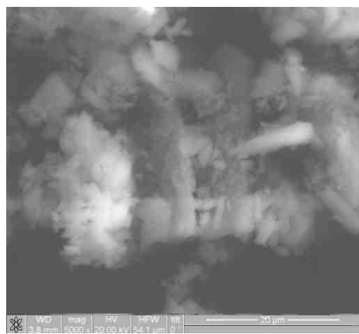
Рис. 4. Микрофотография субстанции карнозина после 5 минут измельчения (крупный план)
