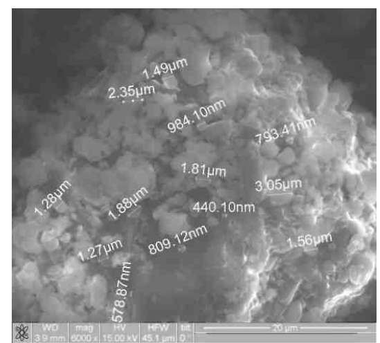
Рис. 10. Микрофотография субстанции парацетамола после 45 минут измельчения (крупный план)
