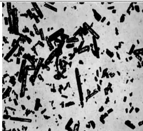
Рис. 3. Микрофотография исходной субстанции таурина (световая микроскопия, 4X)
