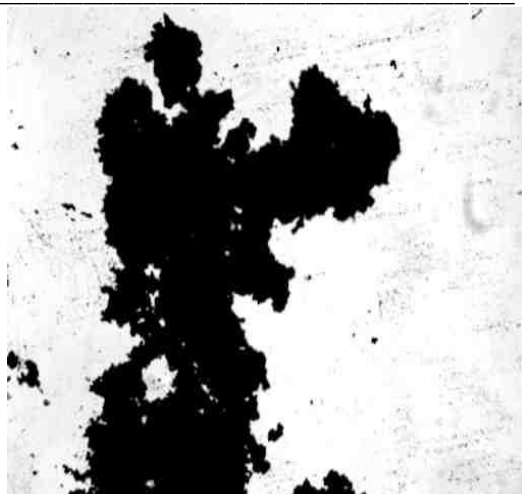
Рис. 16. Микрофотография субстанции таурина после 30 минут измельчения (световая микроскопия, 4X, крупный план)
