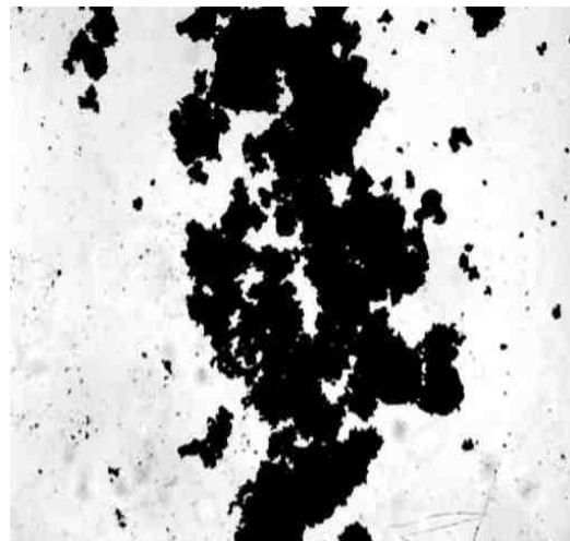
Рис. 20. Микрофотография субстанции таурина после 45 минут измельчения (световая микроскопия, 4X, крупный план)
